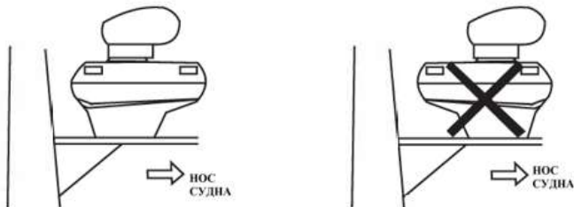
Рисунок 3. Ориентация антенного блока радарной антенны МИРАН «АМ-18»
